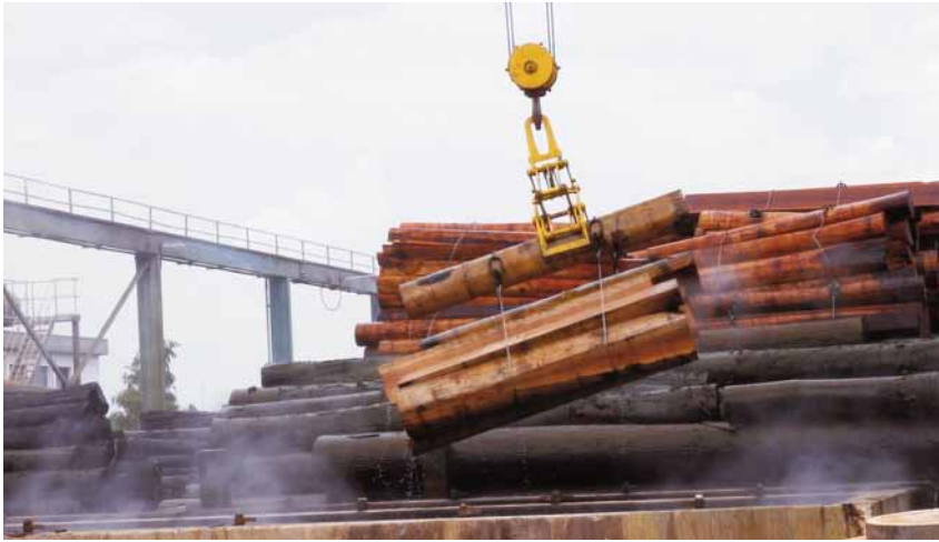
Bei der Furnierproduktion muss das Holz im Wasserbad »kochen«. Die Hersteller haben daher einen hohen Wasserbedarf.
